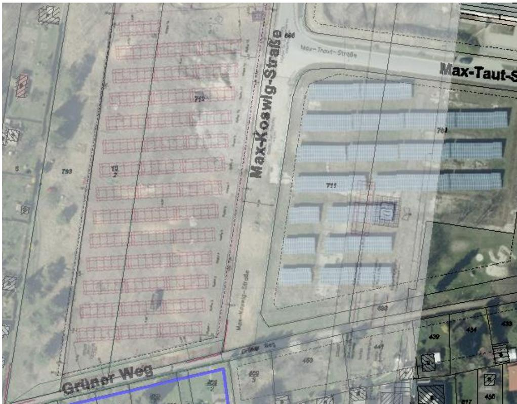
Abbildung 6: Westanlage auf den Flurstücken 10/2 und 712 (Modulreihen rot gezeichnet) und Ostanlage in Google Earth Luftbild erkennbar unter Verwendung von Geobasisdaten: ©GeoBasis-DE/LGB
