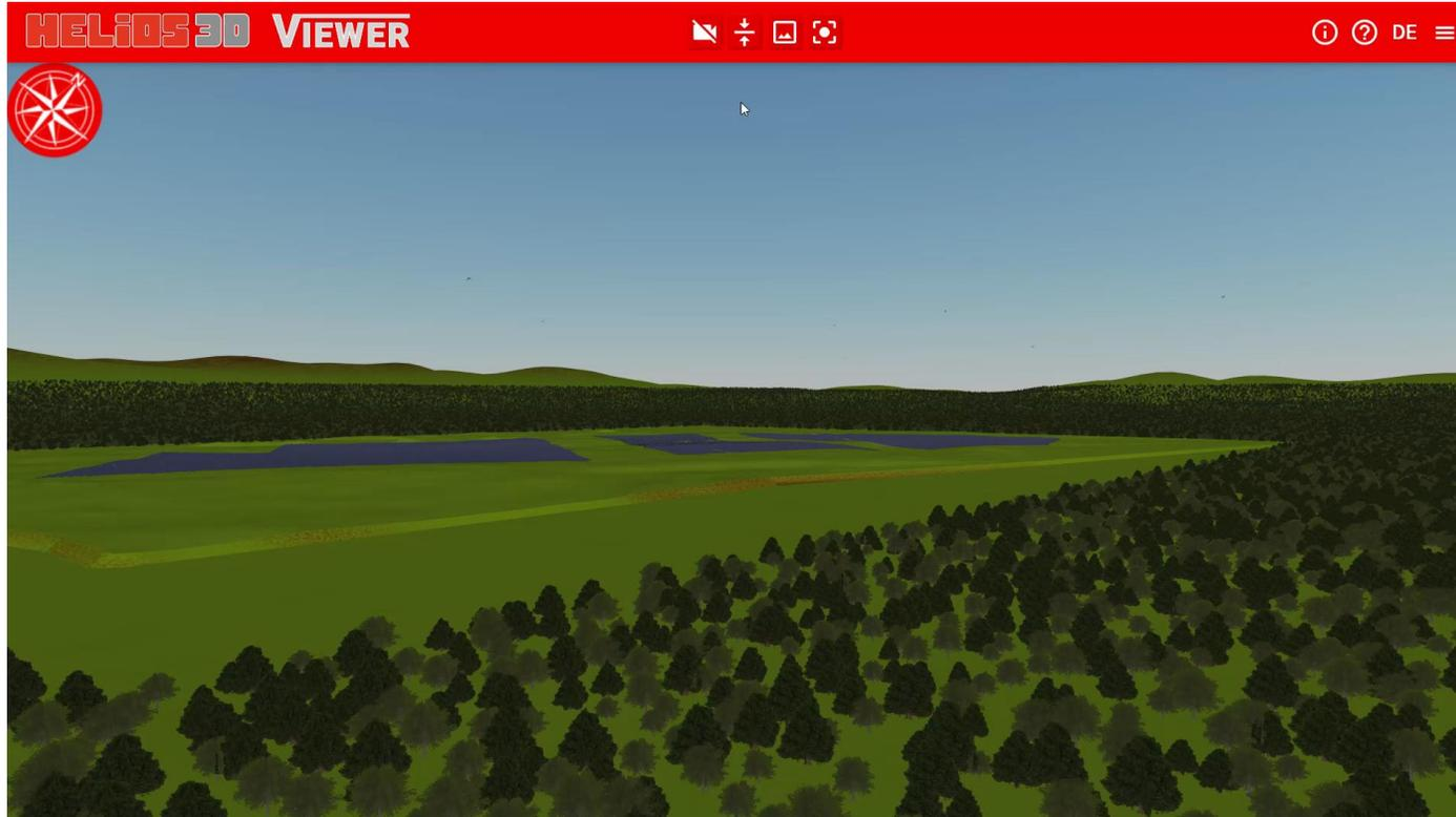
Generell haben die Modultische ein **Nord-Süd-Ausrichtung** mit einem **Reihenabstand von 4,5m**.
