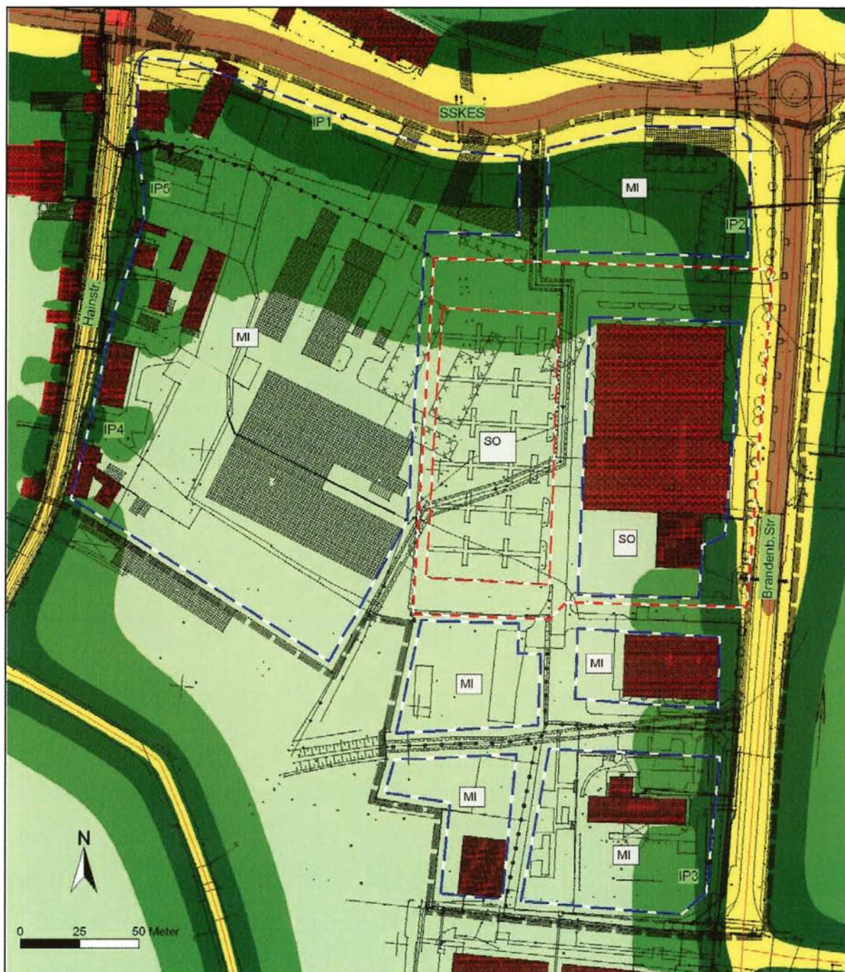
Bild 3 Maßgeblicher Außenlärmpegel nach DIN 4109
