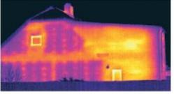
Thermografieaufnahme: linker Bereich zweischaliges Mauerwerk mit Dämmstoff ausgeblasen, rechter Bereich ohne Dämmung
