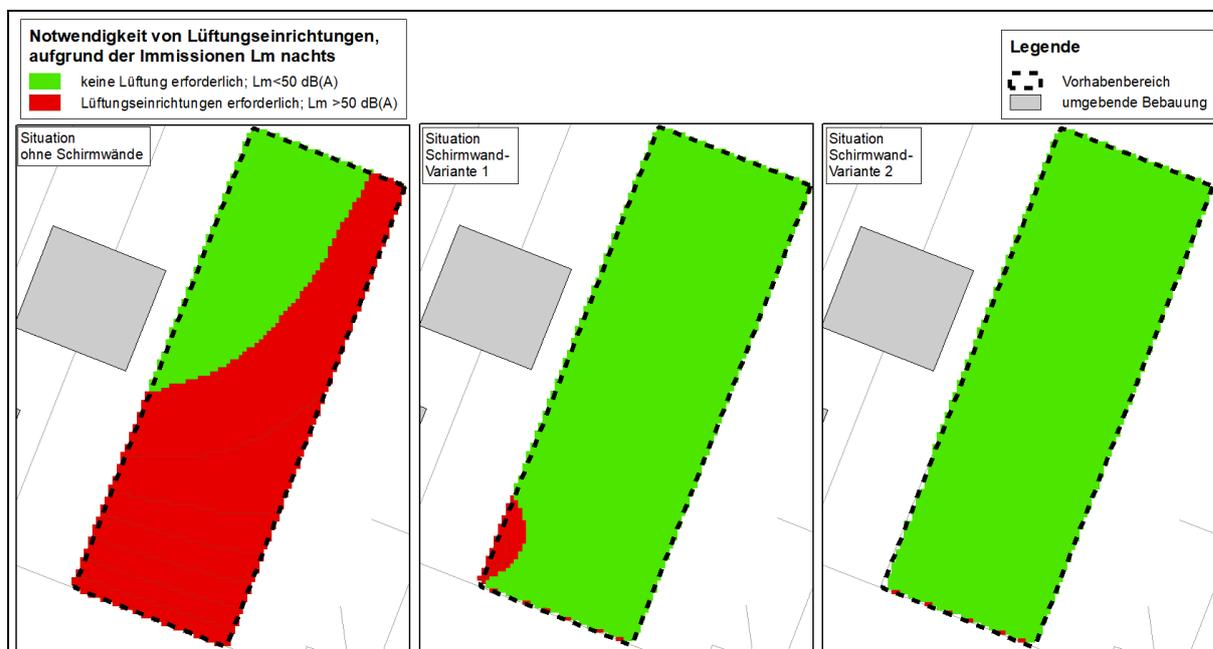
**ABBILDUNG 6:** Prinzipdarstellung (Ampelsymbolik) der Immissionssituation im Plangebiet für den Nachtzeitraum hinsichtlich der Notwendigkeit von Lüftungseinrichtungen; Situation ohne Lärmschutz sowie mit Schirmwand der Variante 1 bzw. Variante 2
